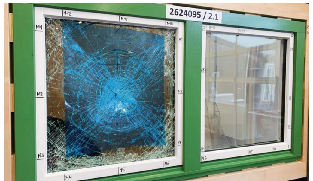
Mundo de productos "Seguridad" ¡Prueba superada! Grünbeck fabrica ventanas de madera de una y dos hojas con el herraje oscilobaciente Roto NX hasta la clase de resistencia RC 3.
