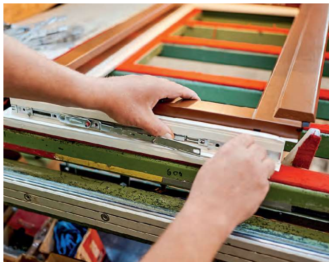
La carpintería Pötschke fabrica elementos oscilobatientes con herrajes del programa Roto NX. El lado de bisagra completamente oculto Roto NX | C, apto para hojas de hasta 180 kg, fue adoptado por la empresa como uno de los primeros en Alemania.
