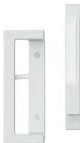
La manilla Look: en el lado interior, el bloqueo se abre mediante una palanca integrada en la manilla de la puerta corredera. Opcionalmente, puede cerrarse adicionalmente con una llave. Desde el exterior, solo es visible un discreto uñero.
