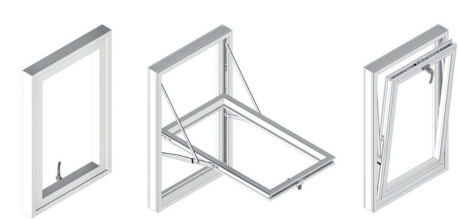
Para limpiar la parte exterior de la hoja, solo hay que girar la manilla, abrir el elemento, empujar la hoja hacia afuera y girarla completamente.
