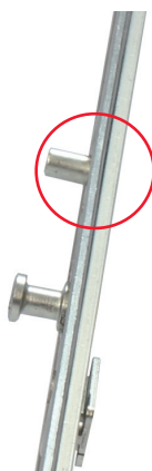
El pin anti elevación de la cremo- na funciona como palanca y evita el robo
